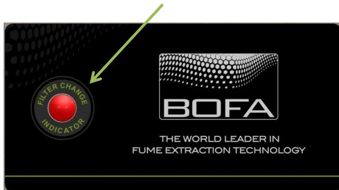
Первым обычно нуждается в замене предварительный фильтр, служащий защитой основного комбинированного фильтра от засорения крупными частицами. При появлении индикации сначала замените предварительный фильтр, а потом комбинированный, если не помогло.
